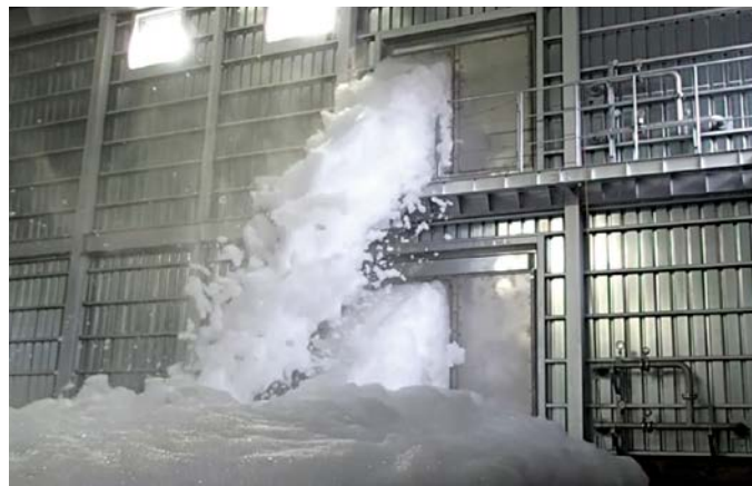
自動車運搬船の車両艙に使用される発泡器の発泡実験
