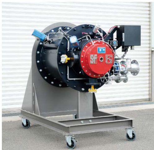
サンフレムと共同開発を進めるアンモニア専焼バーナー「NEXAMO」
