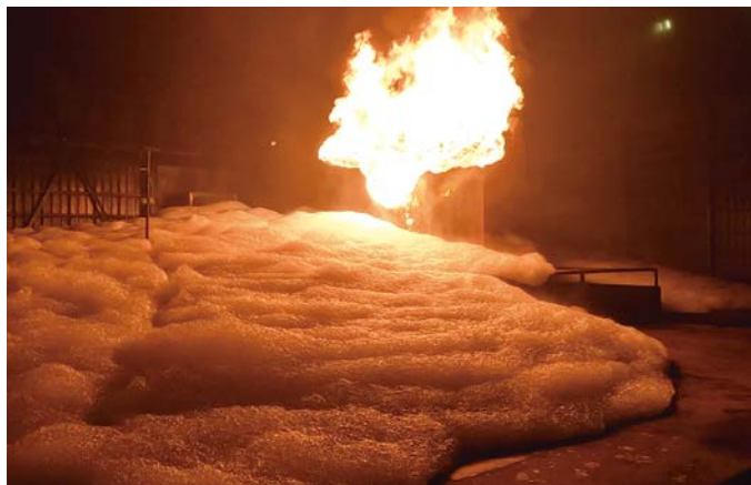
高膨張泡消火装置による泡消火実験
